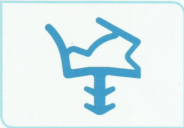
Querschnitt einer originalen Türdichtung (Quelle: Deventer)
